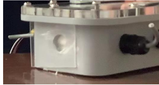
図4 コードを固定するジョイントとカメラ用の穴
