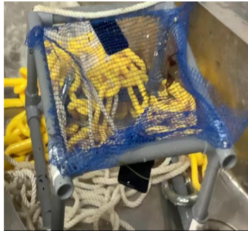
図5 耐水殻を固定する枠
