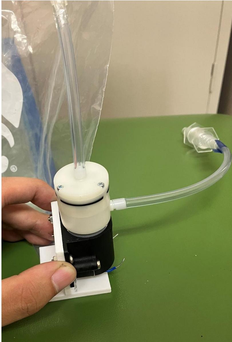
図 16 空気回収袋及びエアポンプとの接続図
