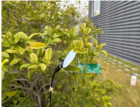
図 11 葉濡れセンサの試験
